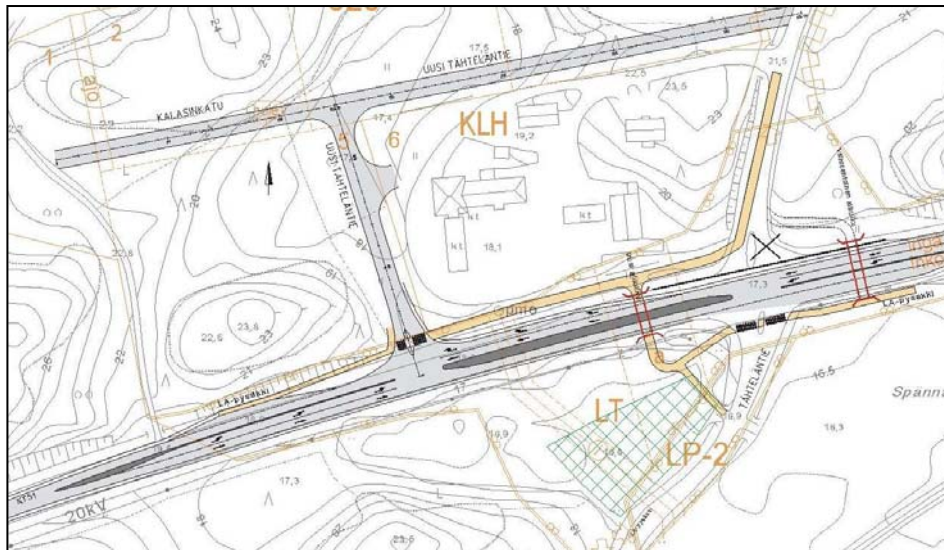
Kuva 11: Vaihtoehtoverailussa käytetty vasen-oikea-porrastettu suunnitelma. FCG 2018.
