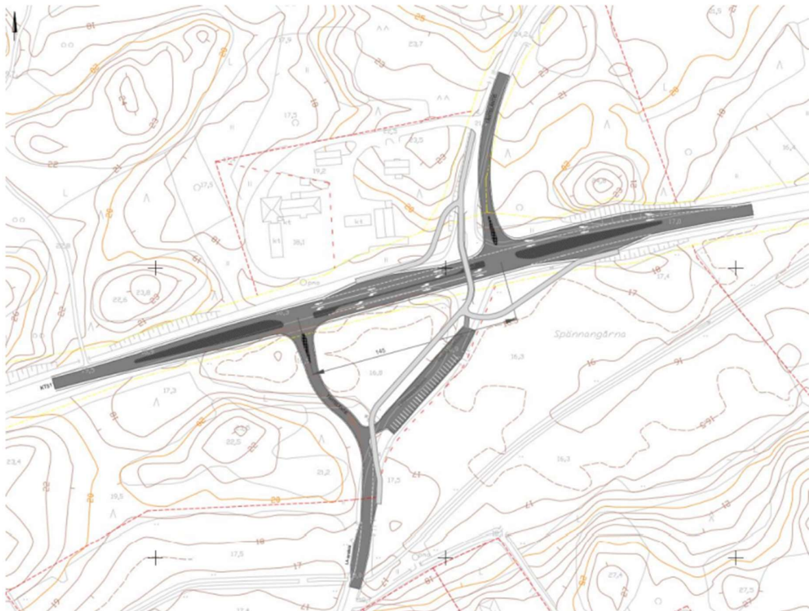
Bild 12: I anslutningsutredningen rekommenderas att den fortsatta planeringen görs enligt övergångsalternativet för gång- och cykeltrafik. (Sweco Oy, 2021).
