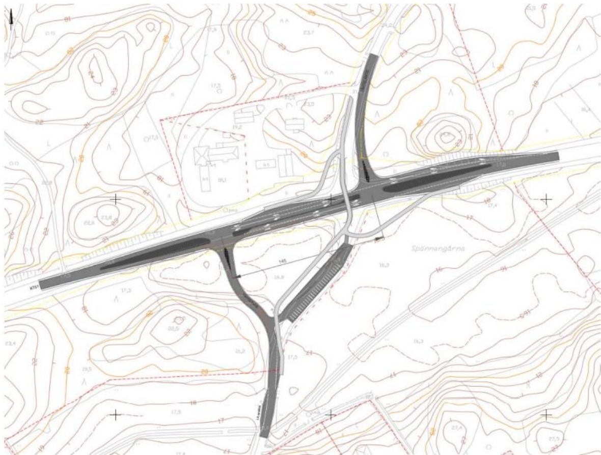
Kuva 12: Liittymäselvityksessä jatkosuunnittelua varten suositeltu Tähteläntien liittymän kehittämissuunnitelma jalankulun ja pyöräilyn ylikulkuvaihtoehtoilla (Sweco Oy, 2021).
