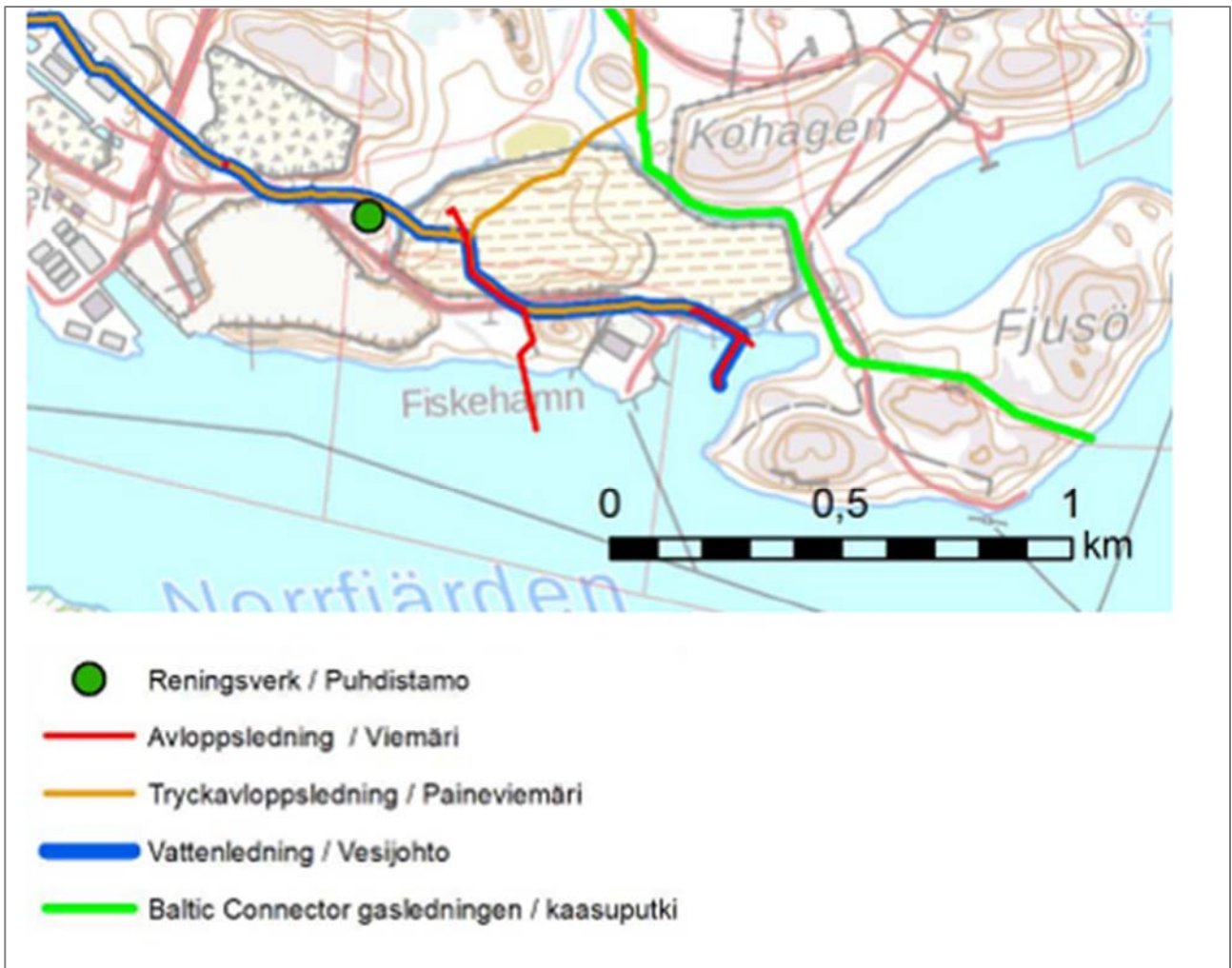
Kuva 3-30. Kunnan vesi- ja viemäriverkko (vuoden 2015 tilanne). Lähde: Joddböle III kaavaselostus, Sitowise 2019, mukailtu.
