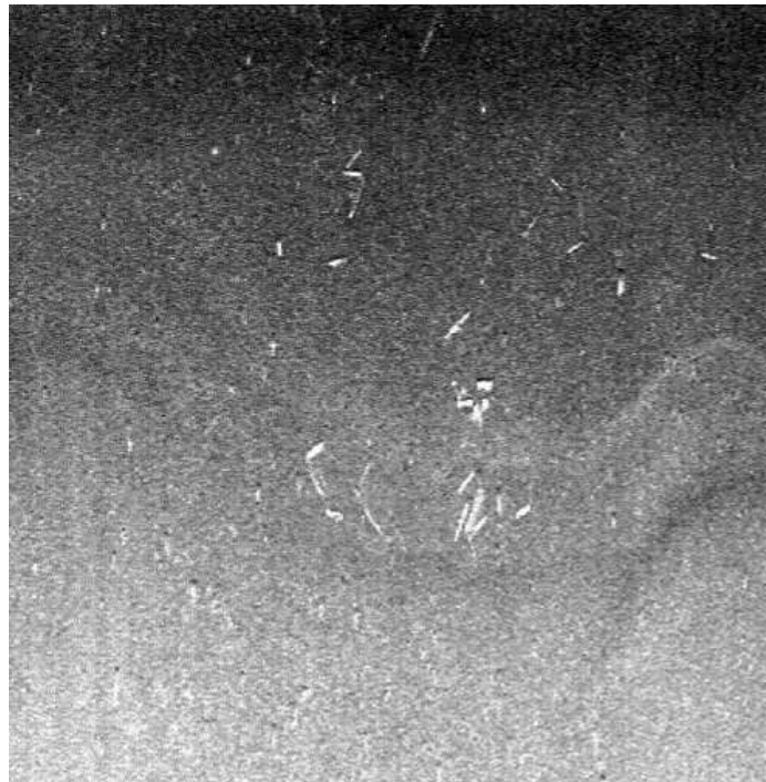
Kuva 6. Luonnollisesta pohjasta poikkeavia kohteita (mahdollisia hylynosia) Ramsjöskatanin kärjestä noin 250 m etelään (Syssleffjärdenin väylän kekellä). Yksittäisten kappaleiden pituus n. 1,5-4 m. Vesialueella runsaasti yksittäisiä kohteita myös muualla. X=6653034 Y=2499920 (KKJ peruskoordinaatisto). Viistokaikukuva © Finnish Consulting Group Oy
