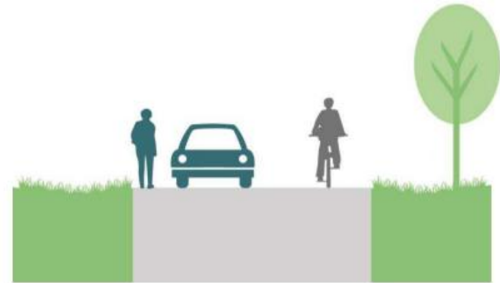
Bild 13. I lugn trafikmiljö kan alla färdmedel dela samma utrymme. Källa: Cykeltrafikens planeringsdirektiv.
